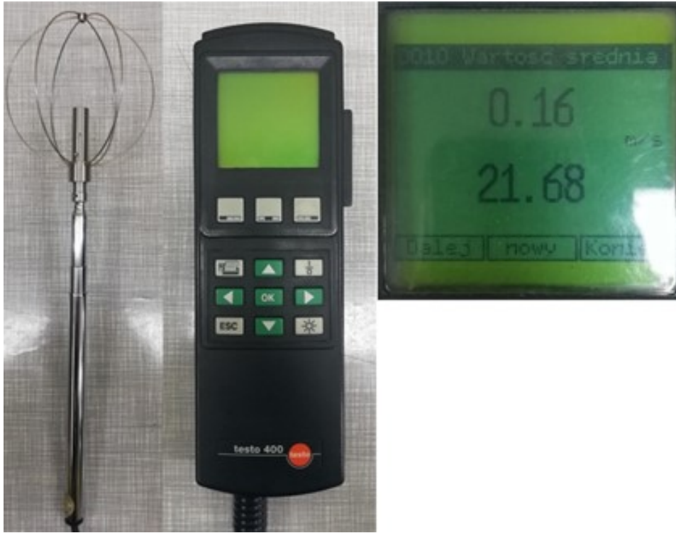
Rysunek 6: Wykorzystywane urządzenie pomiarowe oraz wyświetlacz Testo 400 z przykładowym pomiarem.
