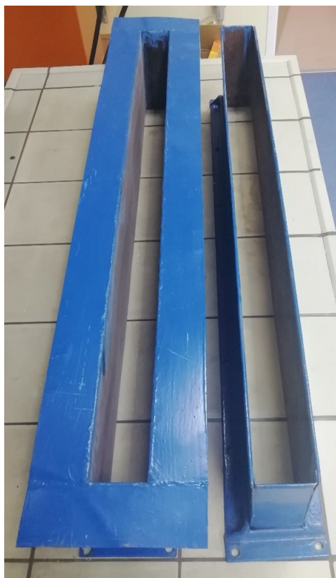
Rysunek 5: Ssawki wykorzystywane w doświadczeniu. Po lewej ssawka kołnierzowa, po prawej ssawka bosa.
