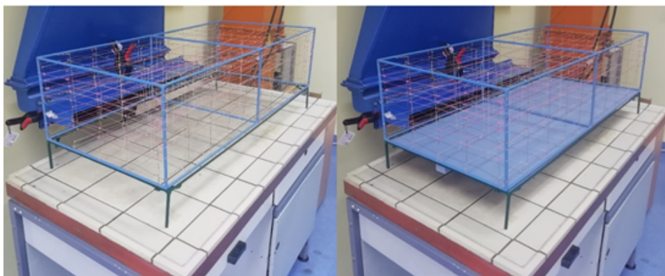
Rysunek 1: Siatka pomiarowa bez (po lewej) i z blatem ograniczającym (po prawej) na stanowisku pomiarowym.
