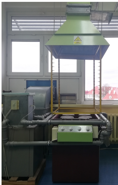
Rysunek 5: Stanowisko pomiarowe składa się z okapu, źródła ciepła (kuchenka) oraz wentylatora nawiewu osłonowego widocznego po lewej stronie.
