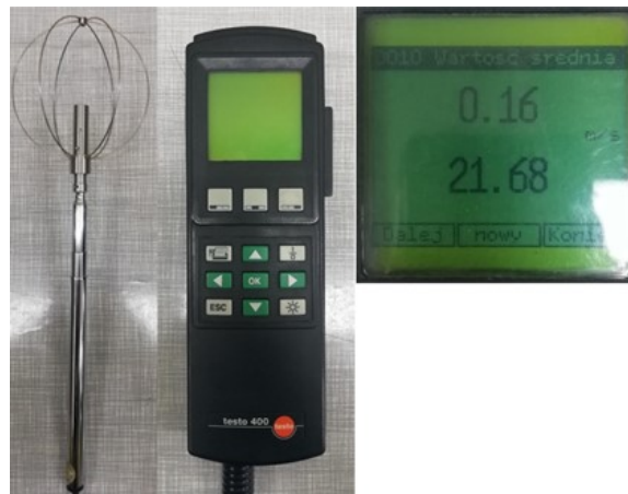
Rysunek 3: Wykorzystywane urządzenie pomiarowe oraz wyświetlacz Testo 400 z przykładowym pomiarem.
